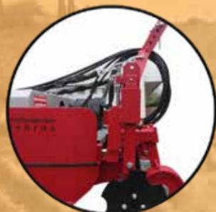
Mit hydraulischer höhen und Tiefeneinstellung der Seitenanbaugeräte
