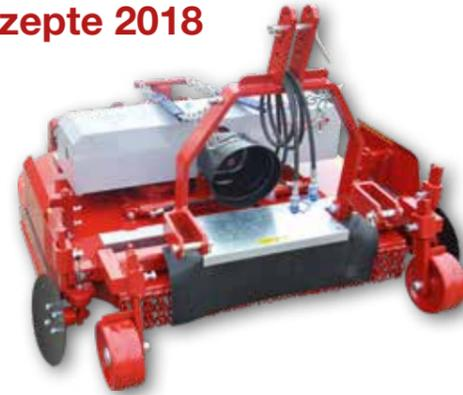
Die Maschinenkombination kann frei nach Ihren Wünschen gewählt werden. In den vorderen Aufnahmen des Mulchgerätes können Pflugscheiben oder Rollhacke angebaut werden. An der hinteren Aufnahme kann eine Fingerhake oder ähnliche Geräte aus unserem Hause angebracht werden.
