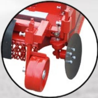
Mulchgerät mit festehenden Räder, Trägerführungsrohr und Pflugscheiben
