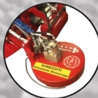
Schwenkscheibe mit beweglichen Messern, hydraulisch angetrieben und mit hydraulischer Abtastung
