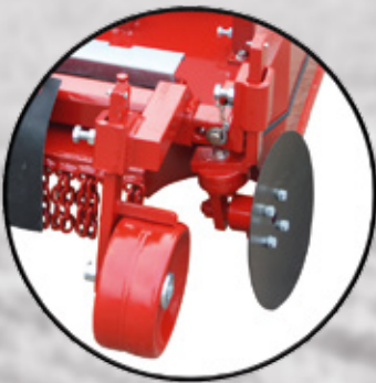
Mulchgerät mit feste- henden Räder, Trägerführungsrohr und Pflugscheiben
